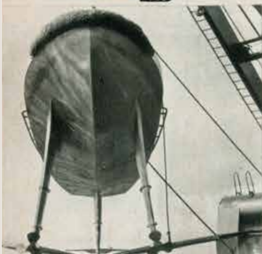
L'ing. Friedrich Wendel di Amburgo costruì nel 1958 un aliscafo di 3500 Kg. di peso ad ali totalmente immerse, che, con 2 motori da 90 HP, toccò i 60 Km/h.
