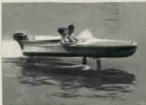
Il "Nixy", di produzione ungherese, ha una lunghezza di m. 3,75, una larghezza di m. 1,82, un peso di 150 kg. e un pescaggio variante da 40 a 15 centimetri.
