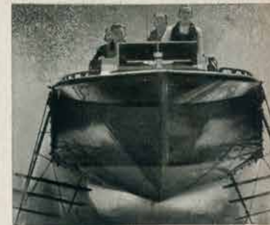
Le alette a "scala a pioli", inventate dal Forlanini, furono adottate dall'aliscafo canadese "Bras D'Or", che navigò nel 1954.
