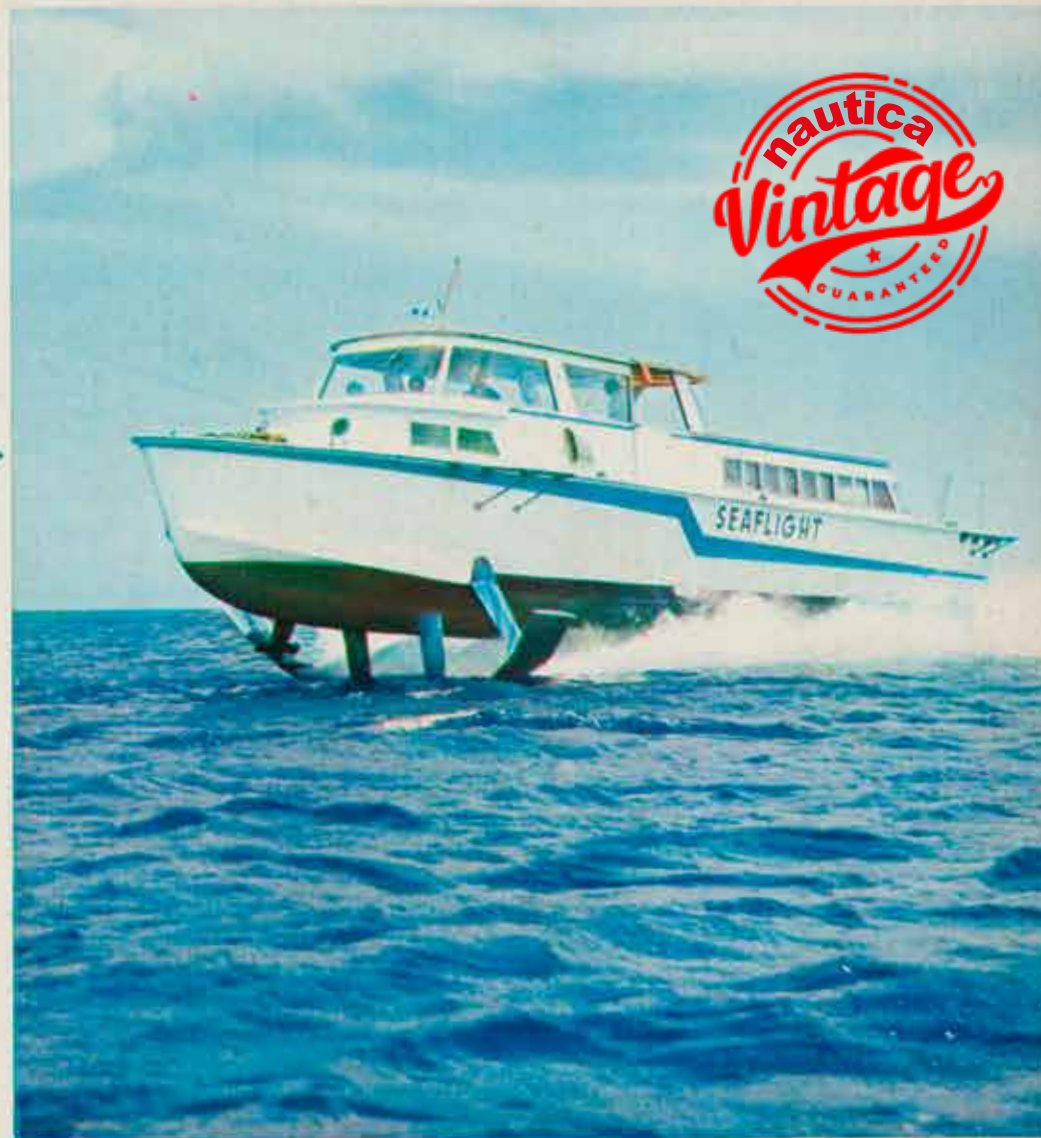
Il "Seaflight" viene presentato nelle due versioni cruiser notturno e cruiser diurno. Dispone di alette a V che hanno la possibilità di spostarsi rispetto a un asse trasversale.
