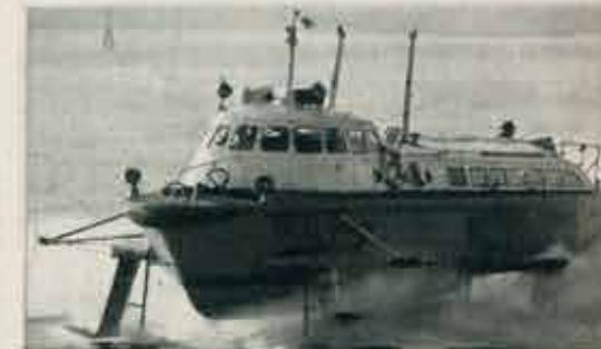
L'aliscafo utilizzato dalla Shell per i trasferimenti dei tecnici negli impianti del Sud America costruito in Olanda raggiunge i 58 Km/h.
