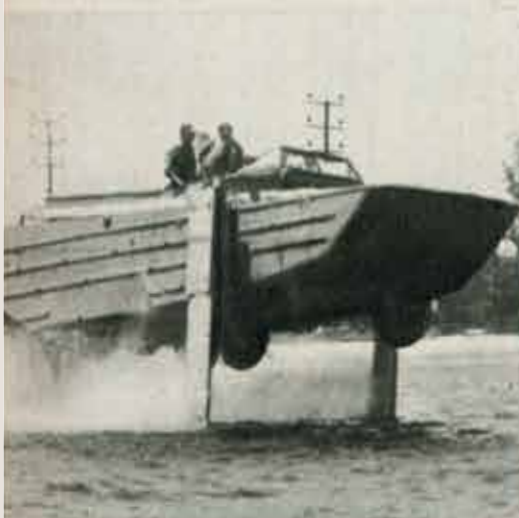
Un mezzo anfibio dell'esercito americano, opportunamente attrezzato, ha fornito interessanti indicazioni sul sistema di sostentamento ad ali immerse.
