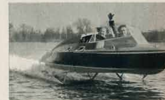
Questo aliscafo da turismo, presentato nel 1953 a Berlino da Johannes Herz, raggiunse gli 80 Km/h con un motore Porsche da 55 HP.
